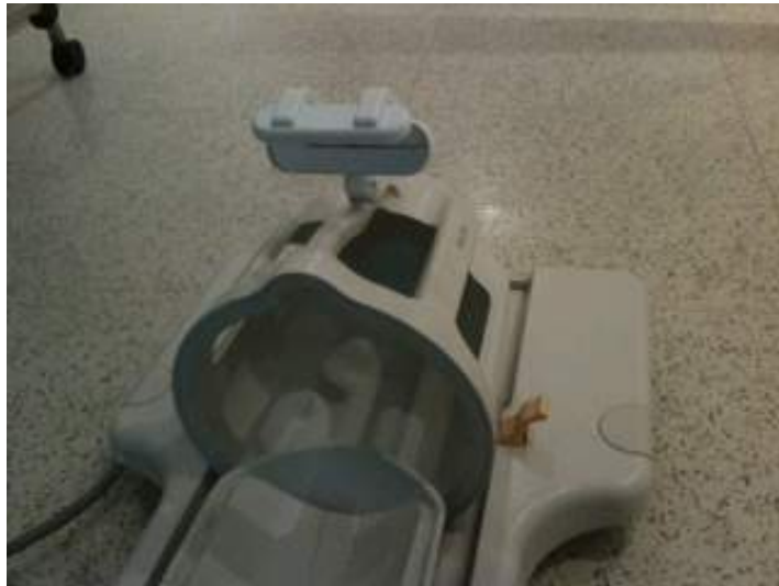
Bobine de tête avec système de miroirs
